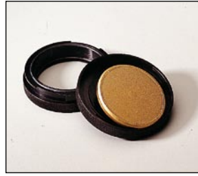
Fondo riflettente dorato 0,1, 0,2 o 0,3 mm per celle con chiusura a baionetta. Adatto alla misura di liquidi o grassi. Progettato per mantenere la costanza del cammino ottico anche se si sostituisce il vetro.
