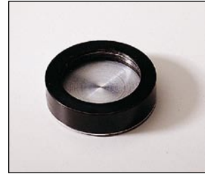
Cella con chiusura a baionetta cella tonda a chiusura ermetica. Raccomandata come cella di controllo
